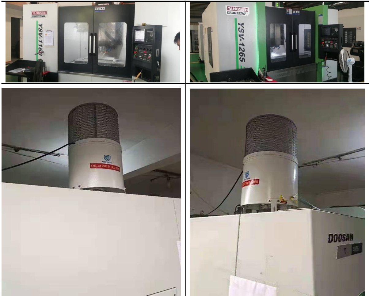
图 3-1 设备密闭加工及油雾收集器
